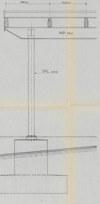
\* aanzicht laatste spantpoot \*
