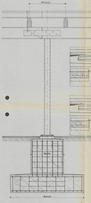
\* doorsnede t.p.v. verbinding liggers INP 330 \*
