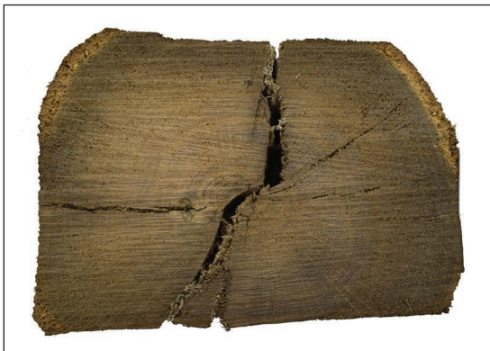
Afb. 49. Monster van eikenhout, afkomstig van de noordwestelijke stijl. Links- en rechtsboven is spinthout aanwezig.
