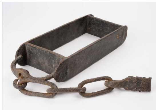
Afbeelding 23b. Standaard ijzeren mal voor bakstenen in Leiden (bron: Lensen 2015, 34. Collectie museum de Lakenhal).
