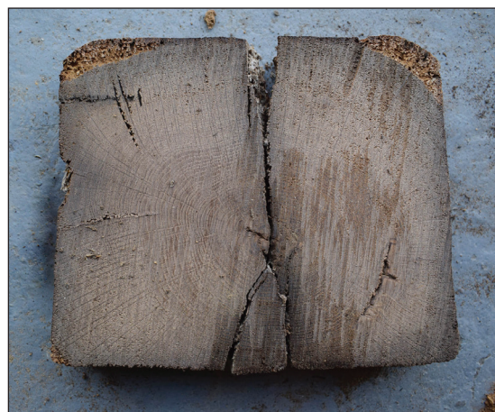
Afb. 32. Houtmonster van de noordoostelijke stijl. Het gaat om langzaam gegroeid eikenhout.
