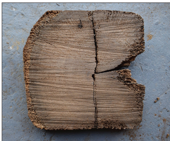
Afb. 31. Houtmonster van de zuidelijke dekbalk. Het gaat om langzaam gegroeid eikenhout.
