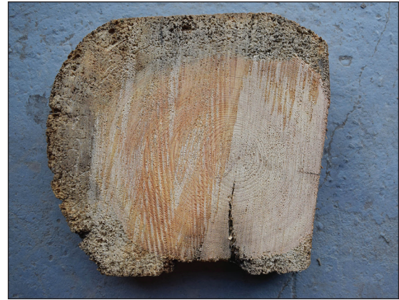
Afb. 54. Houtmonster van de overstekbalk.
