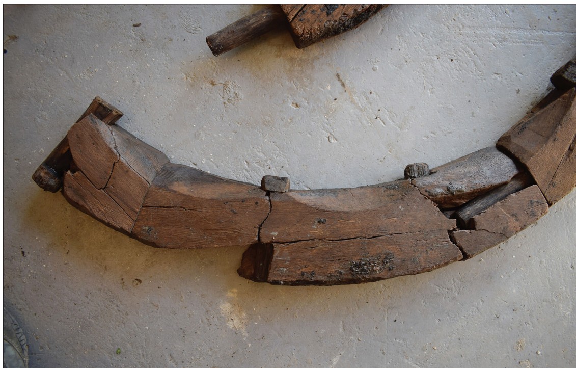
Afb. 121. Detail van de afgeschuinde hoeken en afgezaagde spaken.
