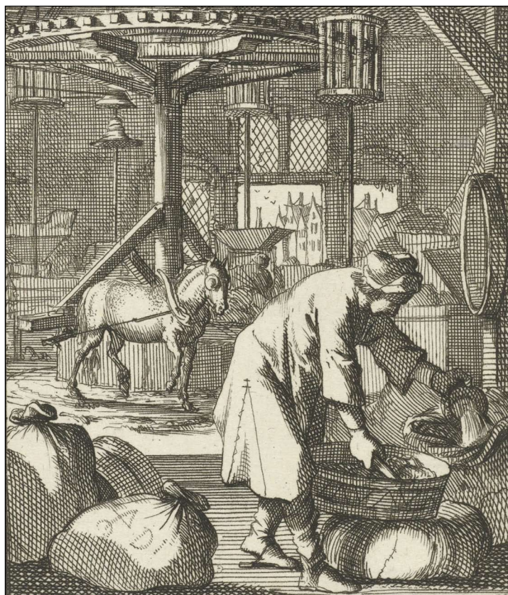
Afb. 15 Een grutterij op een prent van Jan Luyken uit 1694. Links de rosmolen met het kroonwiel en een paard. Collectie Rijksmuseum, Amsterdam.
