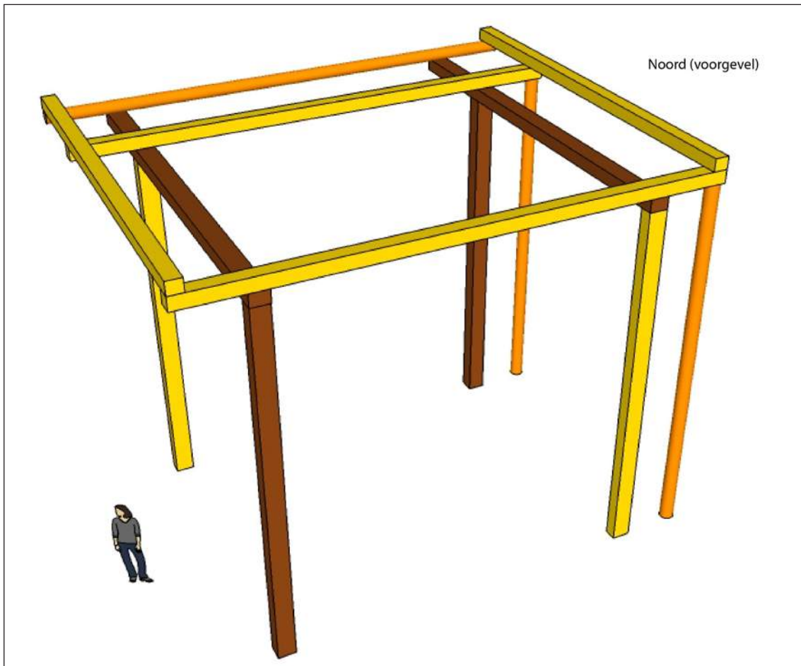
Afb. 81. Vereenvoudigde reconstructie van het vierkant van de boerderij. In bruin de elementen van eikenhout, in geel de elementen van grenenhout, in oranje elementen van naaldhout die uit de 19 de -20 ste eeuw dateren.
