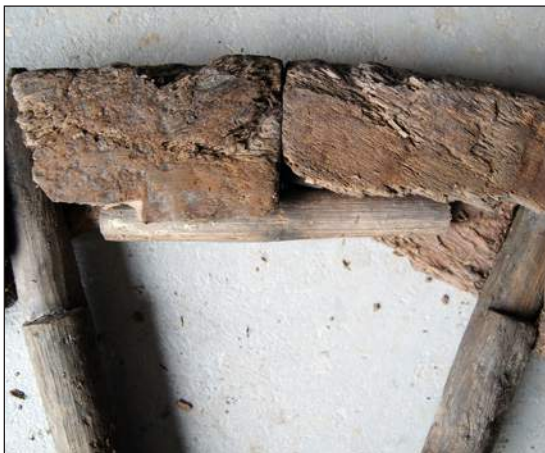
Afb. 34. Een eikenhouten pen als verbinding tussen de wioldelen.
