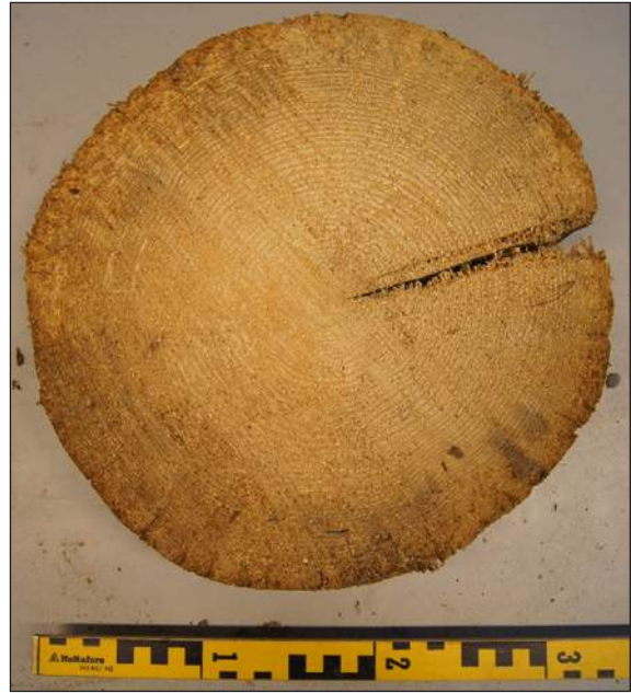
Afb. 94. Houtmonster van een element van waarschijnlijk fijnspar.
