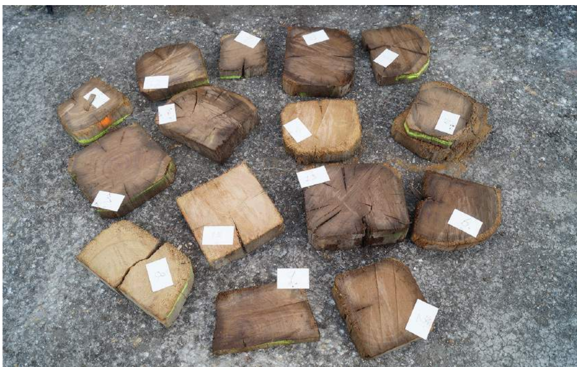
Afbeelding 11. Vers gezaagde houtmonsters van een stompboerderij. Middelweg 25 in Opmeer.
