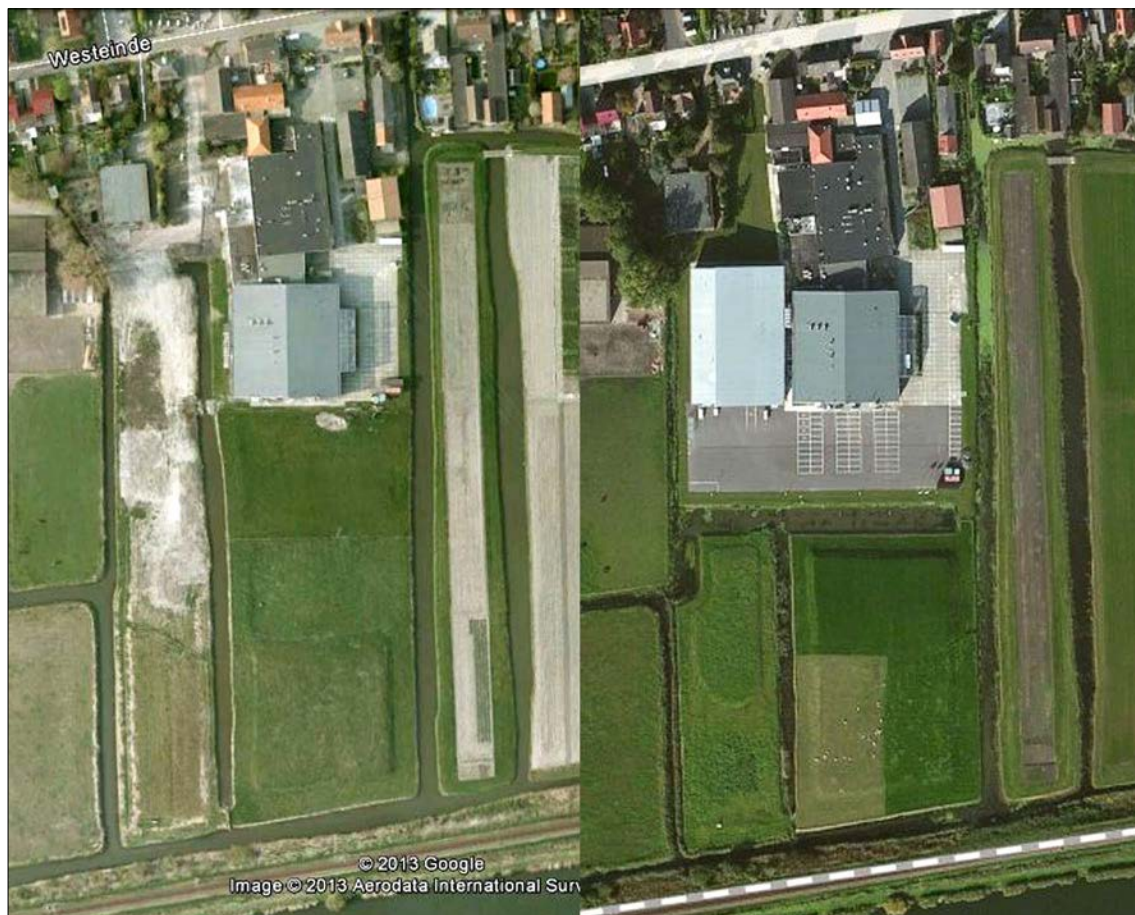
Afb. 2 De omgeving van het plangebied vanuit de lucht. Vergelijk de foto links met rechts. Een aantal oude sloten is dichtgegooid, nieuwe werden gegraven. Op de foto rechts is in de hoek rechtsonder net ten noorden van het spoorlijn een groot gronddepot zichtbaar.
