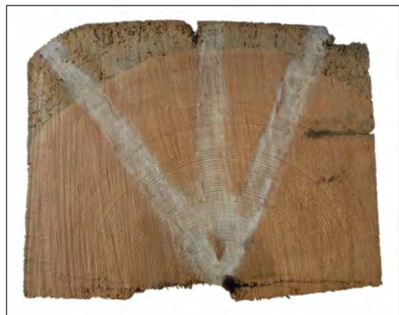
Afb. 40 Monster 1 na het dendrochronologisch onderzoek: de witte banen zijn de gemeten radialen.
