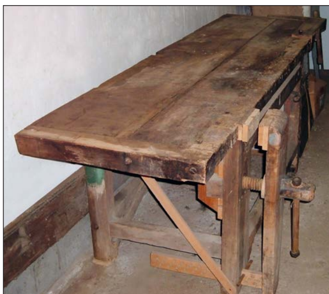
71. Voorbeeld van een werkbank uit de 19 de eeuw met een houten bankschroef
